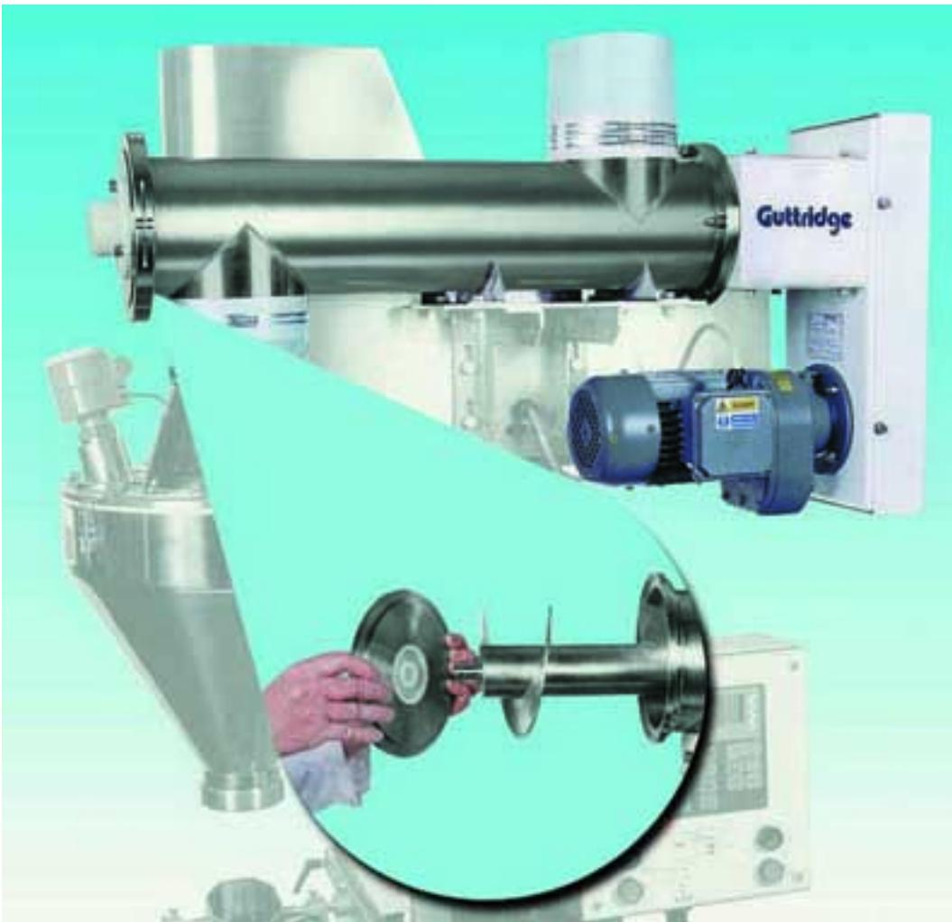
Der Guttridge Augaflo ist eine hochwertiger horizontaler Querförderschnecke zum Einsatz mit Schnreckendosieranlagen. Durch elektrische Integrierung des Augaflos mit einem Fullstandsmelder montiert im Ladetrichter der Dosieranlage, kann ein konstanter, sehr gleichmäßiger Produktdruck im Ladetrichter realisiert werden. Hierdurch werden die Endresultate der Dosierungen in Hinsicht auf Genauigkeit positiv beeinflußt, womit eine erhebliche Kostenbesparung entsteht.
